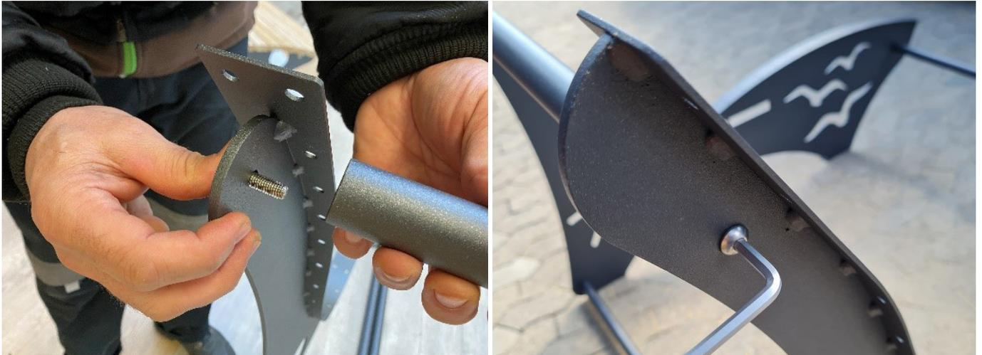
Die beiden Seitenteile (**Pos. 1**) mit den Querstreben (**Pos. 3**) und den Schrauben (**Pos. 4**) verschrauben und zunächst nur **handfest** anziehen. Zwei der Querstreben müssen zum Anschrauben der Latten noch einmal entfernt werden.
